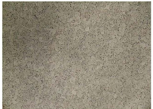
ภาพ Micrograph ของท่อที่บริเวณที่ไม่เกิดความเสียหายจาก Creep อยู่ (Green zone)
