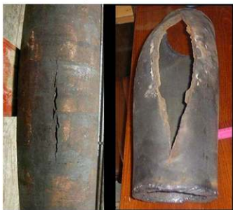
ตัวอย่างการเกิด Creep ที่ทำให้วัสดุขาดออกจากกัน
