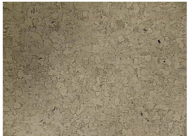
ภาพ Micrograph ของท่อที่บริเวณที่ไม่เกิดความเสียหายจาก Creep อยู่ (Green zone)
